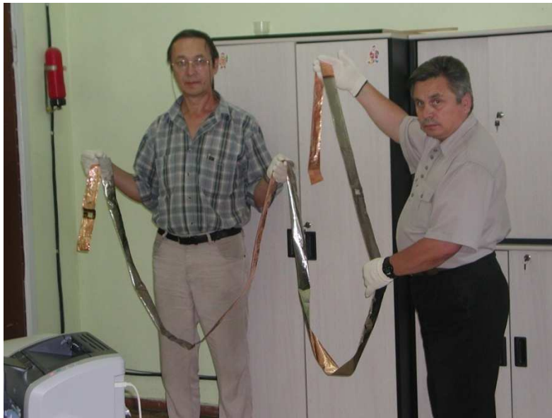
Tape superconductor \text{Nb}_3\text{Sn} , T_c=16\text{K}
