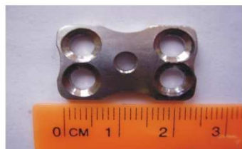
Пластины для травматологии и ортопедии, изготовленные из титана VT1-0
