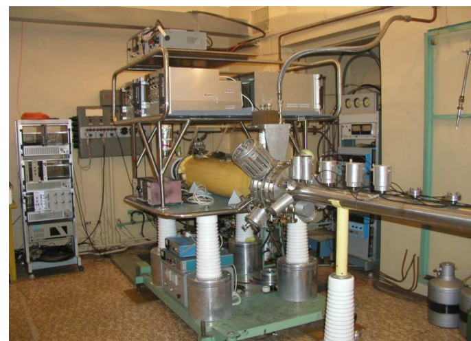
Электронно-струнный ионный источник ЛВЭ ОИЯИ
